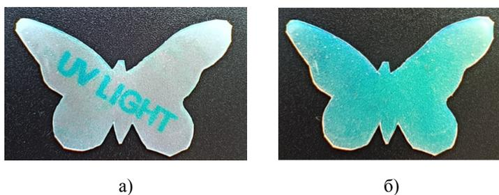
**Рис. 3.** Фотографии пленки на основе ПВХ, содержащей 11 % ХЖК смеси с хирально-фотохромным допантом: а) облученная УФ светом через маску; б) облученная УФ светом без маски
