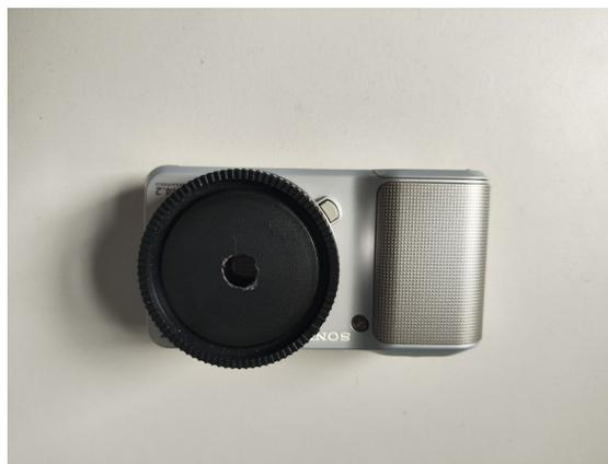
б) образец гиперспектрометра с диафрагмой
