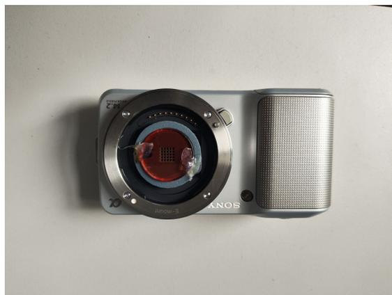
а) камера с закрепленной на бленде линзой
