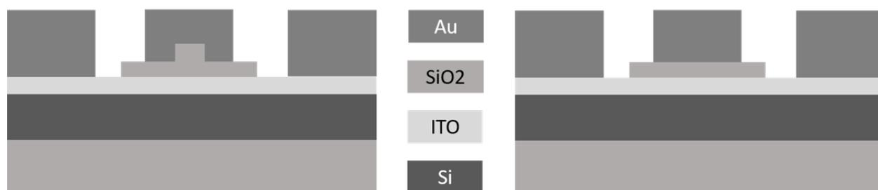
**Рис. 1.** Схематические изображения поперечных сечений ТЕ (слева) и ТМ (справа) модуляторов. Посередине изображены обозначения использованных материалов
