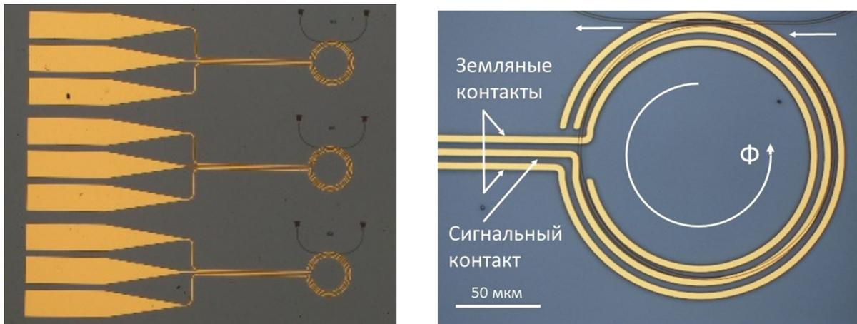
Рис 1. Изображение массива изготовленных структур (а) и расположения контактов на кольцевом микрорезонаторе (б)
